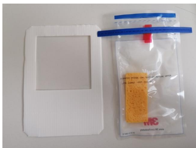
Foto 4: Maschera per delimitazione superficie campionata e spugnette utilizzate per i tamponi delle superfici in acciaio e plastica.
