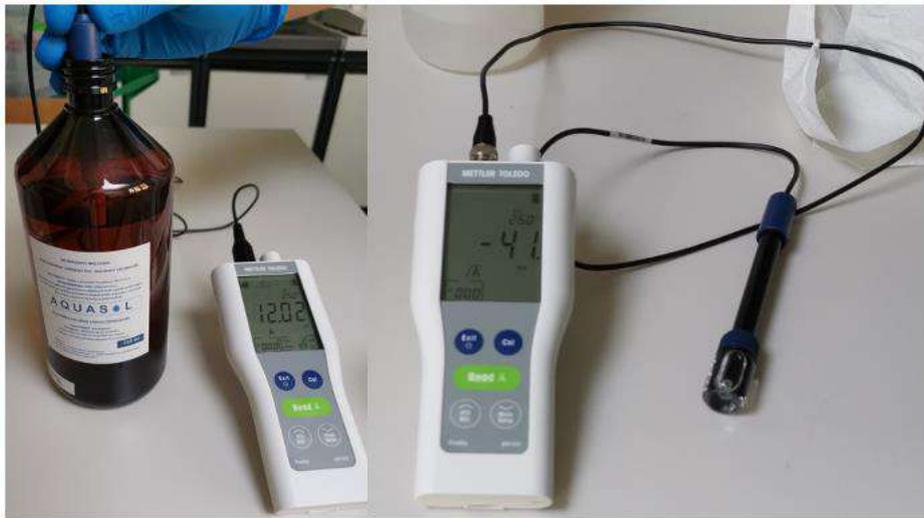
Figura 4. Misurazione pH ed ORP.
